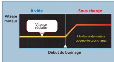
Le régime est automatiquement réduit en marche à vide, réduisant encore d'avantage les vibrations.
