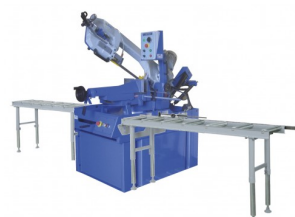
50095 Convoyeur à rouleaux 2000x280 (sans butée) gauche
